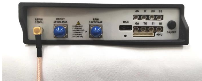
图 8 NXN-45、NXN-60、NXM-60 和 NXM-80 系列设备参考输入接线图
