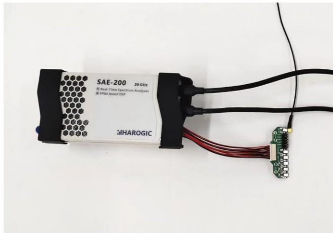
图 28 SAE-90、SAE-200 和 SAN-400 系列设备参考输出接线图
