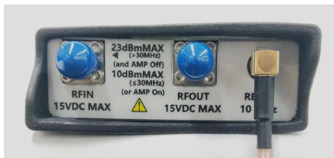
图 3 参考输入口接线详情
