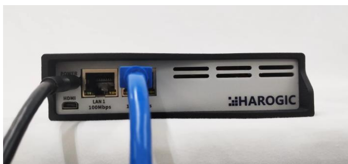
图 10 NXE-90、NXE-200 和 NXN-400 电源线、网线连接
