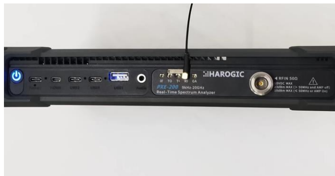
图 13 PX 系列设备参考输入接线图
