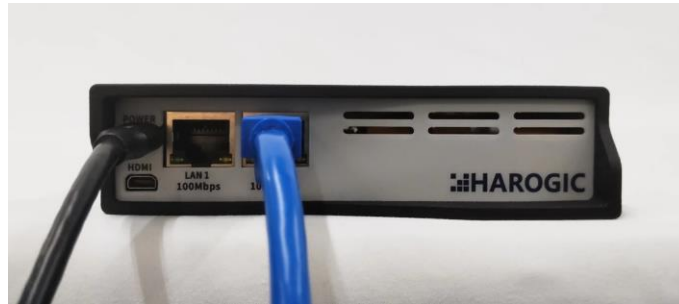
图 7 NXN-45、NXN-60、NXM-60 和 NXM-80 电源线、网线连接
