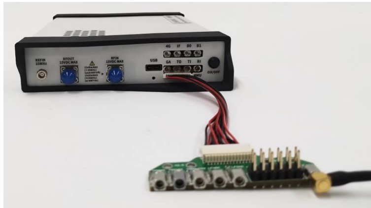
图 29 NXE-90、NXE-200 和 NXN-400 系列设备参考输出接线图
