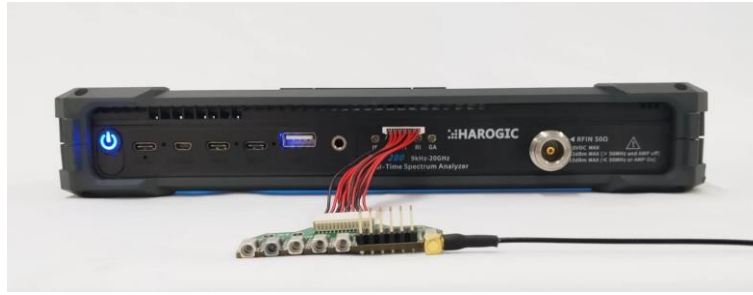
图 30 PX 系列设备参考输出接线图
